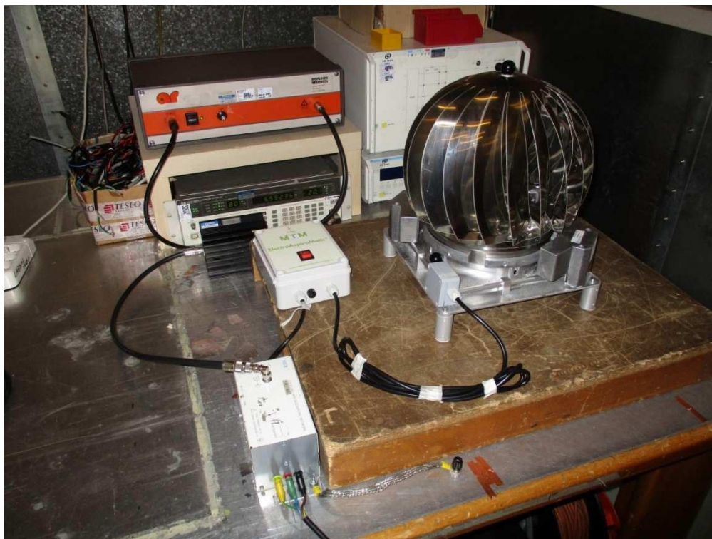
Set-up per immunità condotta sull'alimentazione
